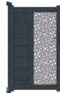
Remplissage avec des lames horizontales de 200mm et tôle decorative verticale.
